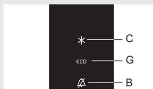
Pour activer la fonction **Eco**, appuyez sur la touche **G**. Lorsque cette option est active, l'appareil fonctionne avec les réglages les mieux adaptés.
